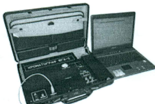
Рис.1. Фотография общего вид хроматографа газового портативного ФГХ.
